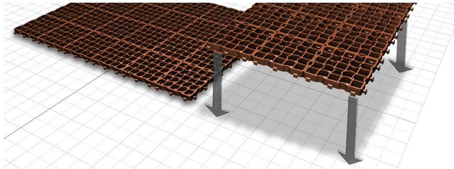
ECORASTER® ist ohne Maschineneinsatz schnell und unkompliziert zu verlegen. Das System wird in vorgesteckten Einheiten zu 12 ECORASTER® (à 33 x 33 cm) geliefert und kann direkt von der Palette in einem Arbeitsgang verlegt werden. Mit nur einem Handgriff sind 1,33 m<sup>2</sup> verlegt.
